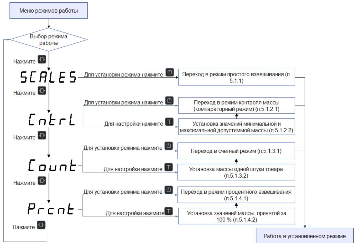
Рисунок 4 – Порядок установки режима работы весов
