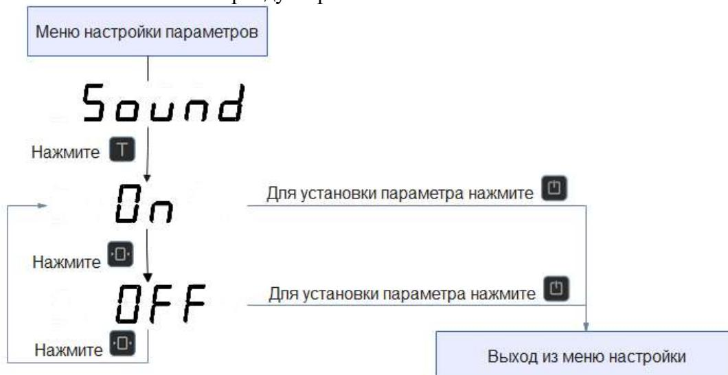
Рисунок 5 – Порядок включения/отключения звукового сигнала
