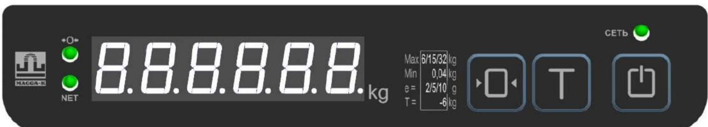
Рисунок 2 – Лицевая панель устройства управления. Клавиатура
